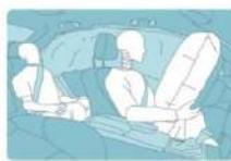
Es un elemento de seguridad complementario al cinturón de seguridad (no lo sustituye) que permite disminuir las consecuencias de un accidente, especialmente en una colisión frontal. Ofrece una protección adicional a la persona para evitar el posible contacto entre el pasajero y el volante, el panel de control y, en algunos casos, las puertas de los vehículos.
